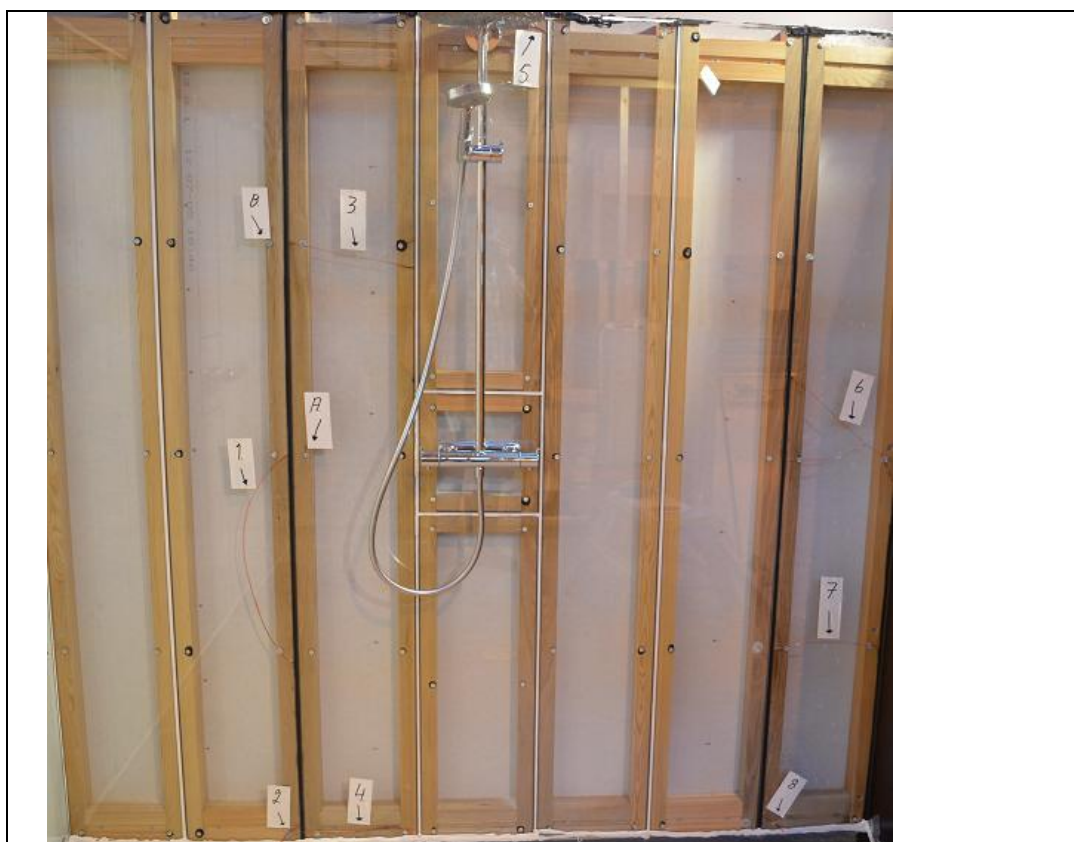
Figur 6: Identifiering av rapporterade skador: No 1-8 Sprickor i glas; A,B Läckage
