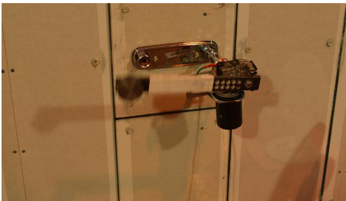
Bild 14. Vvägg 1, dynamisk belastning av blandarfäste mellan vattenbegjutningsperiod 1 och 2.
