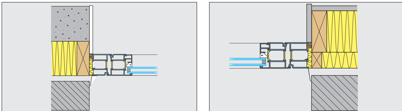
Bild 21, 22. Placering av utvändiga dörrpartier i fasad – betongvägg respektive lättnägg. Partiet ska fästas i den inre delen.
